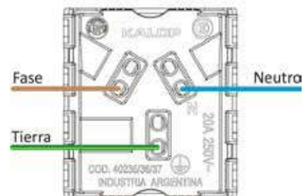
Esquema de conexión de tomacorriente 20A
